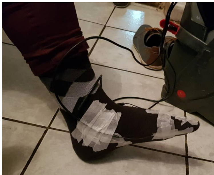
Slika 2. Prikaz namestitve toplotnih senzorjev.
